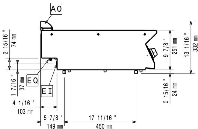
EI = Conexión eléctrica (energía)
